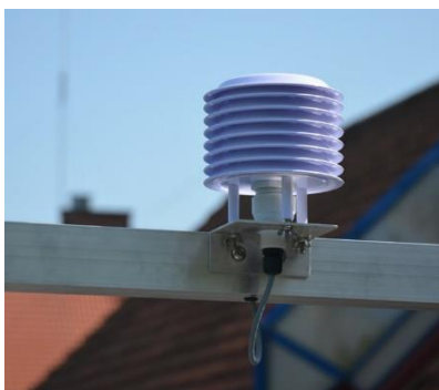
Rys. 1. Przykład montażu czujnika SRH1A w osłonie radiacyjnej
