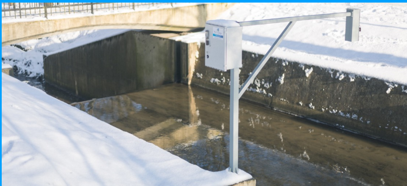
Rysunek 1. Stacja z czujnikiem radarowym do pomiaru poziomu wody AQUA LOGGER RDR
