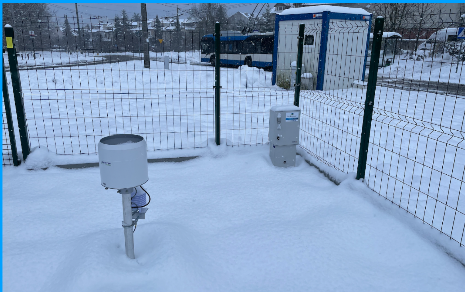
Zdjęcie 1. Przykład deszczomierza korytkowo-wagowego o powierzchni wlotu 400cm 2 zainstalowanego przez PM Ecology w Gdyni.
