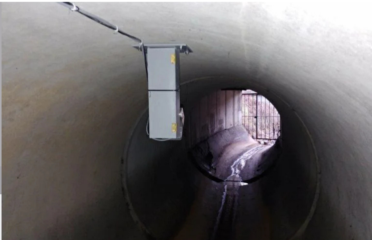
Zdjęcie 2. Sondy urządzenia pomiarowego PM Ecology mierzące ilość zrzutów i ich objętość na kanale wylotowym z przelewu burzowego.
